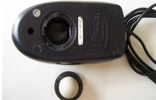
Imagen 19: Ratón Mecánico (Parte Inferior y rodillos)
