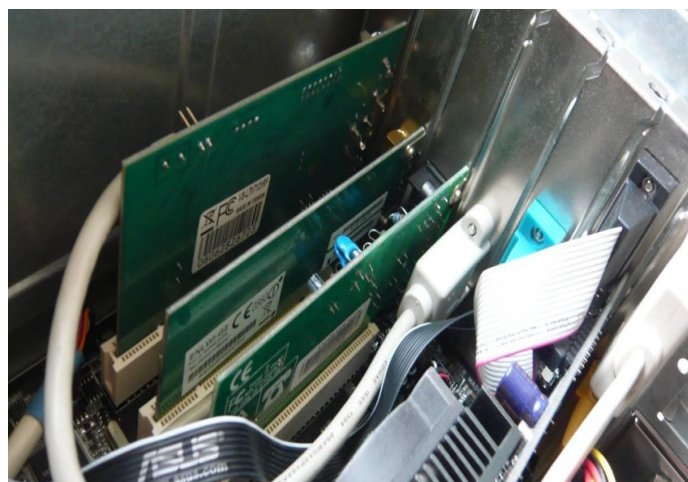
Imagen 9: Tarjetas de expansión Instaladas
