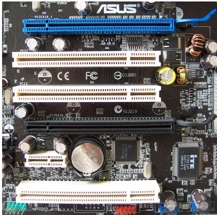
Imagen 8: Slots o ranuras de expansión
