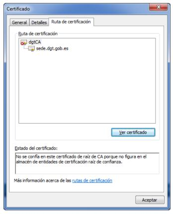
**Ilustración 12** – En este caso la autoridad raíz no pertenece a la comúnmente conocidas. Por tanto el usuario no la tiene dada de alta de fábrica en equipo y la máquina no confiará en ella y los certificados emitidos por ella (se puede apreciar en el aspa de su icono) hasta que el usuario no se dé de alta en el almacén de certificados.
