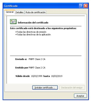
**Ilustración 17** – Instalar un certificado en el almacén de Windows. En este caso se ha hecho haciendo dobleclic sobre el fichero del certificado y pulsando a continuación el botón "Instalar certificado..." que abrirá un asistente de Windows para su instalación.
