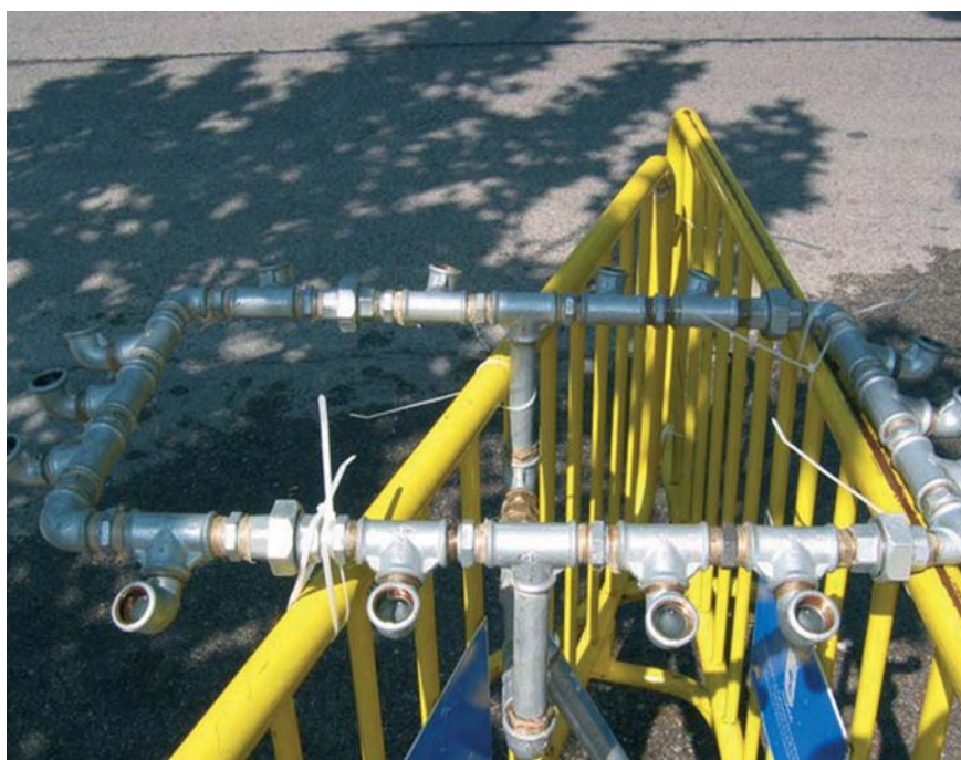
17. Artilugios colocados en las bocas de riego de la «zona húmeda» con el fin de aprovecharlas al máximo para los 5.000 batallistas de media que acuden a cada fiesta, julio de 2004. Foto: www.cofradiamairineravk.com
